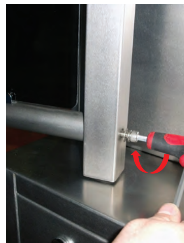
3. Затяните нижний винт
