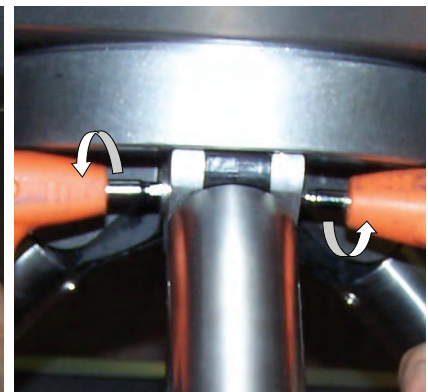
3. Затяните винты (шестигранник 5 мм)
