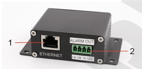
Рис. 3.5. Контроллер NC103 / NC103P
